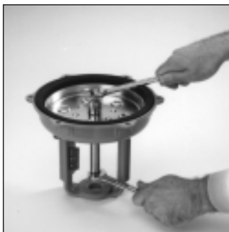
Fig 3 - Remove Stem Nut...
